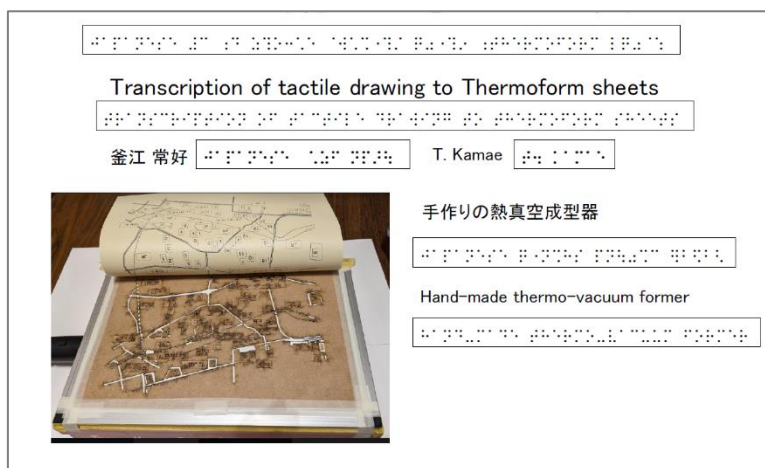
〔図 1〕3D マスターから触覚図や点字を Thermoform に転写
