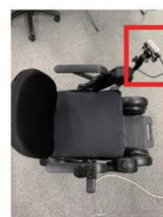
アダプティブフォーメーション機能（電動車椅子WHILL）の肘掛け部分にデブスカメラを装備した様子
